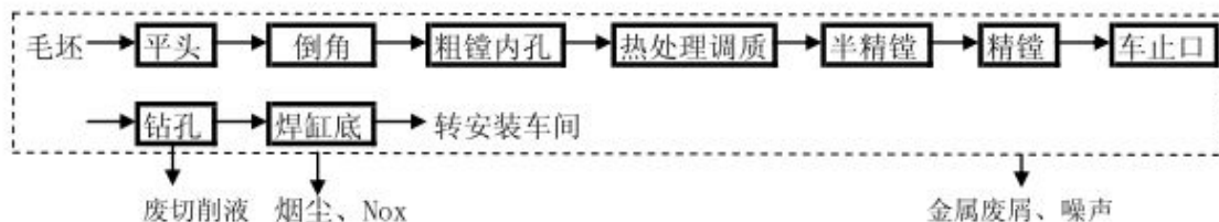
图 3-2 (1) 缸体加工流程及产污环节
