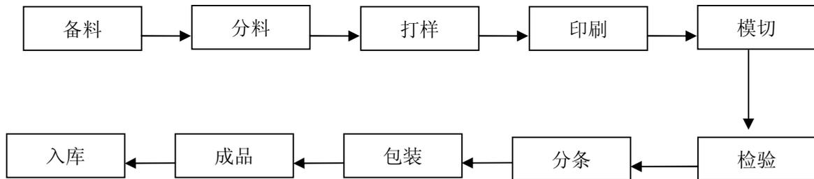
图 1 生产工艺及污染物产出流程图
